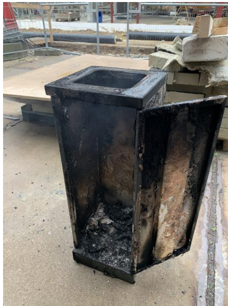
Bica Model 863-065 efter 12 minutter brandtest
